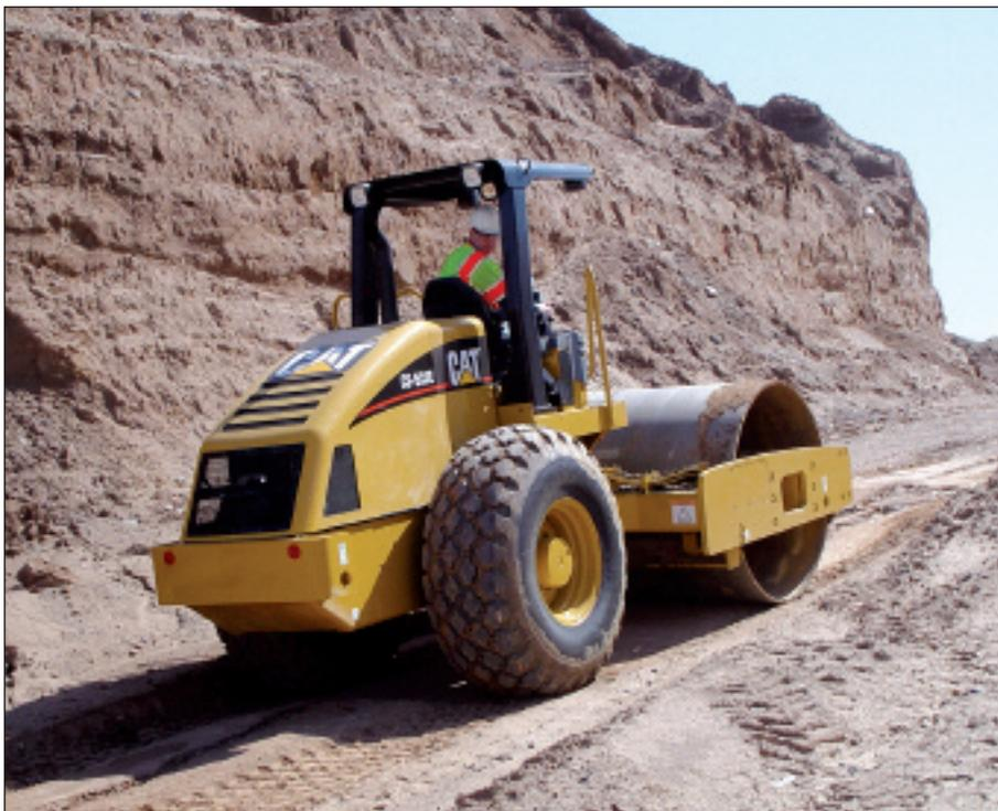
**Sistema com duas bombas de propulsão** possui bombas dedicadas para acionamento dos motores de serviço pesado e alto torque do eixo traseiro e do tambor independentemente. Mesmo quando o tambor ou as rodas começarem a patinar, o motor que não está patinando continua recebendo o fluxo hidráulico, permitindo um esforço de tração contínuo especialmente útil em condições de baixa sustentação do solo.
