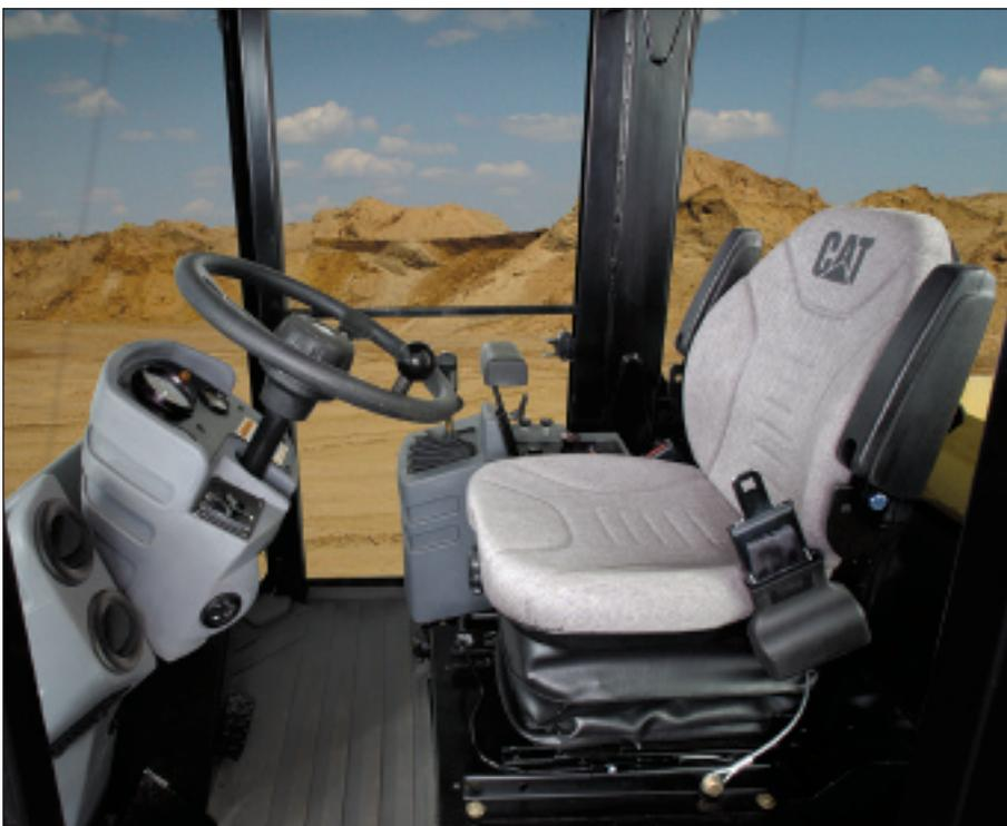
**Alavanca única de controle** da propulsão e da vibração, permite operação simples e baixo esforço. Descanso ajustável para o pulso, para maior conforto.
