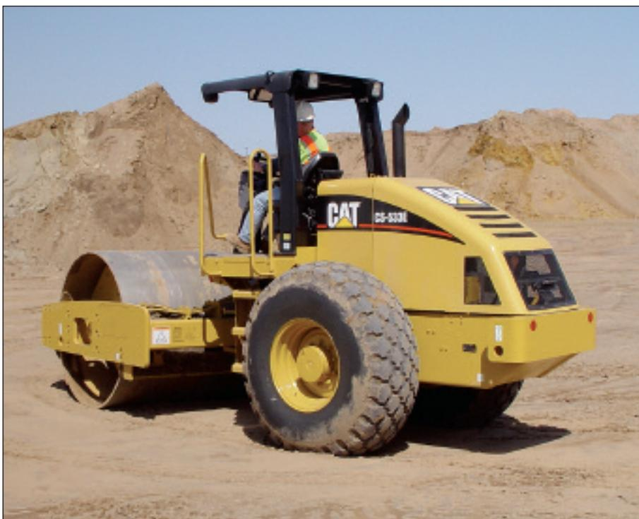
**Visibilidade** para as extremidades dos pneus e traseira da máquina é excepcional. O capô inclinado permite ao operador a visão de obstáculos medindo 1 metro de altura e localizados a 1 metro da traseira da máquina. Excelente visibilidade aumenta a produtividade quando se está trabalhando perto de obstruções ou manobrando dentro do canteiro de obras.
