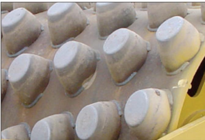
**Este projeto de patas é ideal para compactação de camadas de argila** maiores que 25-45 cm de espessura devido a altura mais alta da pata para uma profunda penetração dentro da camada. A menor área superficial da pata permite maior pressão de contato com o solo para atingir rápida densidade e atender as especificações de densidades restritas.
