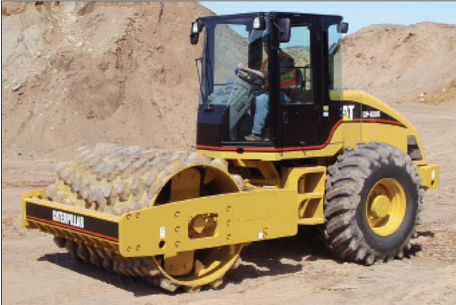
**Raspadores resistentes** montados na frente e atrás do tambor são individualmente ajustáveis e substituíveis. Ajudam a reduzir o excesso de material acumulado entre as patas.
