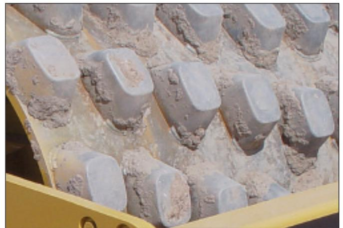
**Este projeto de patas é mais benéfico na compactação de camadas mais finas** com menos de 25 cm de espessura em material semi-coesivo. A menor altura da pata e grande área de superfície permite alta pressão de contato com o solo para atingir especificação típica de densidade fornecendo um melhor fechamento da superfície.
