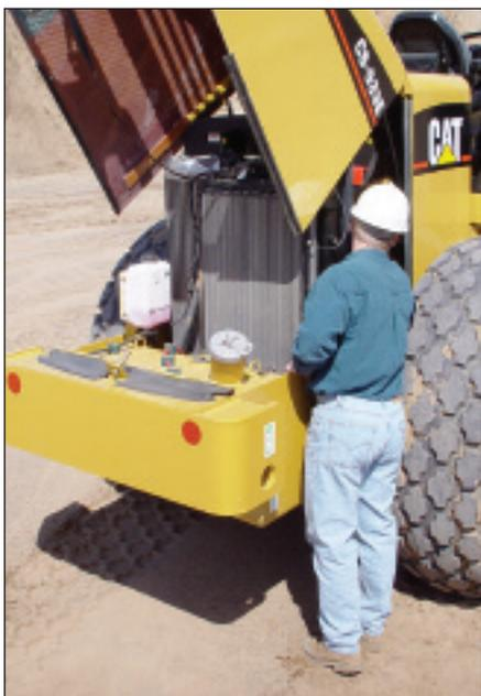
*O capô de fibra de vidro inclina para frente para um bom acesso ao motor e ao sistema de arrefecimento. Pontos de manutenção diários são acessíveis ao nível do solo e agrupados em um lado da máquina.*
